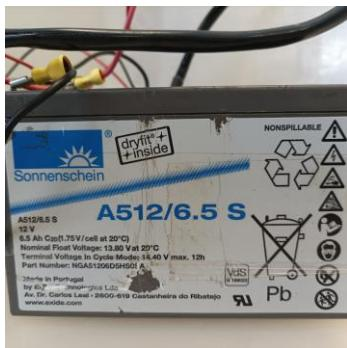
**4.1.** Relever la capacité d'une batterie ainsi que sa tension nominale :  $Q_{bat} =$        $U_{bat} =$
