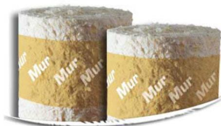
**BATIPLUM** est constitué à 70% de plumes, 10% de laine, 20 % de fibres textiles. Les plumes ayant la capacité à emprisonner une grande quantité d'air et à réguler l'humidité, Batiplum se présente comme une innovation fondamentale en matière d'isolation thermique des murs extérieurs, cloisons et toitures. ( $\lambda = 0,04 \text{ W/m.}^\circ\text{C}$ )
